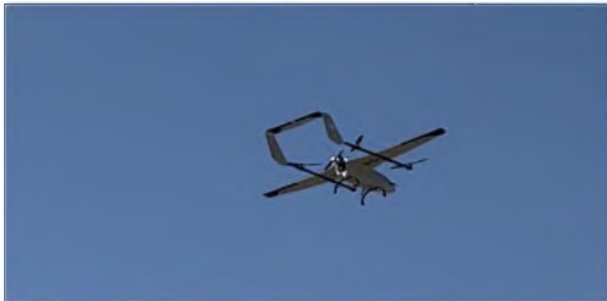
Rys. Zidentyfikowany obiekt latający (BSP zarejestrowany w aplikacji Stramed) w powietrzu na wysokości ok 100m z zamontowanym nadajnikiem/odbiornikiem typu ADS-B
